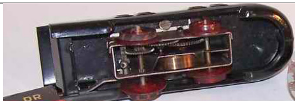
Weimars Uhrwerkantriebe: Links breite Ausführung mit Mittelplatte für Spur 0, rechts schmale Ausführung passend für beide Spuren 0 und S (Fotos von Bernd Tetzel).
