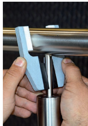
„Abklappen“ der Vorrichtung vom Trägerpin
