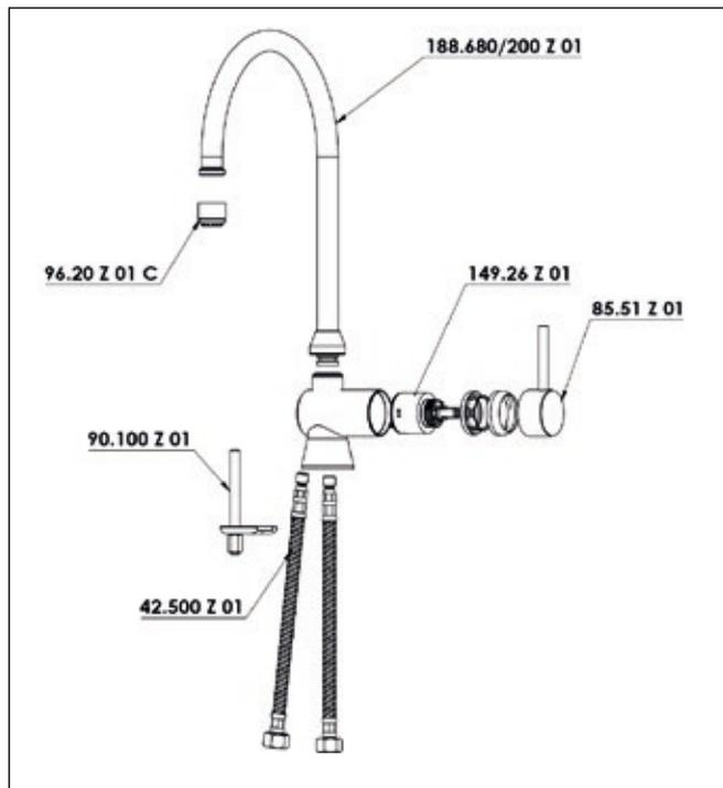
Auslaufmenge 7,5l/min (3bar)
