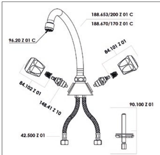
Auslaufmenge 6l/min (3bar)
