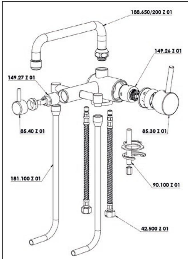
Auslaufmenge 7l/min (3bar)
