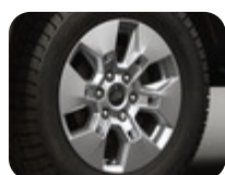
Leichtmetallrad 18" 6-Speichen-Y-Design, Dark Sparkle Silver 8 J x 18", ET 50, für Reifengröße 255/65 R18 – Plug-In Hybrid (PHEV) XLT
