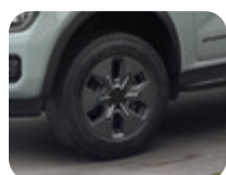
Leichtmetallrad 18" 6-Speichen-Y-Design, Asphalt Matt Black 8 J x 18", ET 50, für Reifengröße 255/65 R18 – Plug-In Hybrid (PHEV) Limited und Wildtrak
