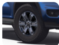
Leichtmetallrad 17" 6-Speichen-Design, Dark Sparkle Silver 7,5 J x 17, ET 55, für Reifengröße 255/70 R17 – XLT, außer Plug-In Hybrid (PHEV)
