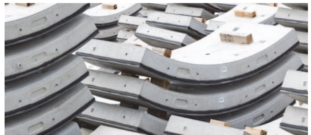
Gebogene Halfenschiene in Tübbing-Elementen
