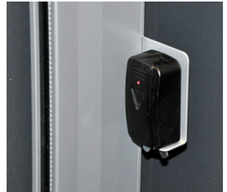
Lichtschranke unten zur Durchfahrtsicherung • Integrierte Befestigungswinkel • Verbesserte Optik, in der Führungsschiene verkabelt • Nur für Rechtsroller
