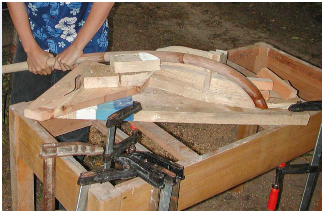
Simeon König beim Biegen der Rattanstangen über einer selbst- gebauten Holz- konstruktion
