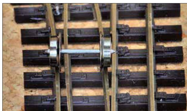
Der sichere Abstand des Schmalspur-Radsatzes zur abliegenden Weichenzunge, die eine andere Polarität aufweist, ist trotz absichtlicher Schrägstellung gegeben. Somit besteht keine Gefahr eines Kurzschlusses beim Befahren einer Dreischienenweiche.
