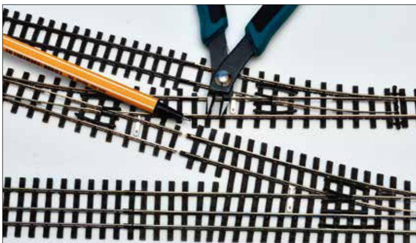
Beim Einsatz von Tillig-Schmalspurweichen sind bei dieser Figur einige Schwellen zu kürzen.
