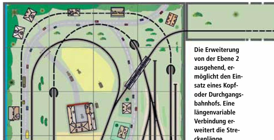
Die Erweiterung von der Ebene 2 ausgehend, ermöglicht den Einsatz eines Kopf- oder Durchgangsbahnhofs. Eine längenvariable Verbindung erweitert die Streckenlänge.
