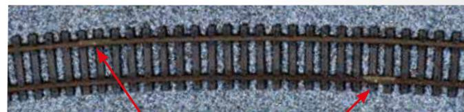
Beim Verlegen von Flexgleis im Gleisbogen sollten die Stoßstellen der Profile versetzt eingebaut werden!
