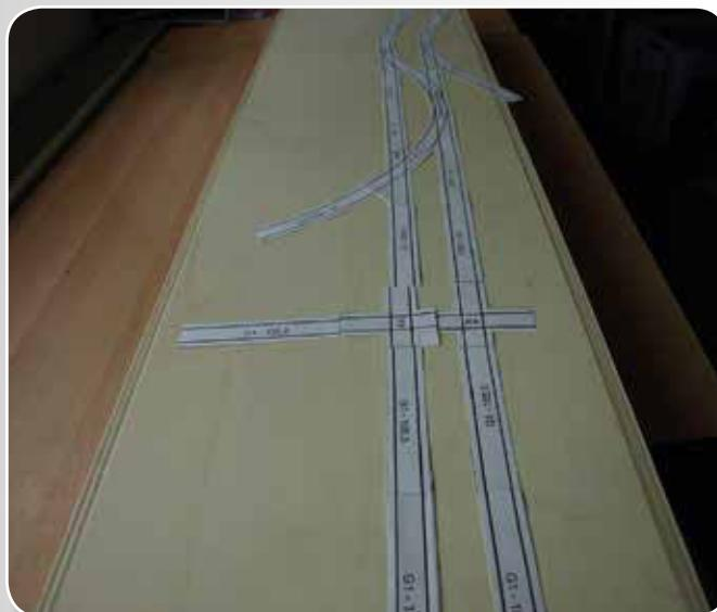
Für die Planung der Gleisgeometrie haben sich die Ausschneideschablonen bewährt (Diese erhalten Sie bei TILLIG auf Anfrage bzw. in Kürze als Download unter [www.tillig.com](http://www.tillig.com)). Bei diesen Ausschneidebögen sind alle vorhandenen Gleisarten als Schablone hinterlegt.
