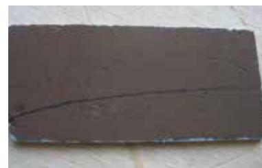
Die Gleisbettung wird umgedreht. Auf der Rückseite werden die durch das Durchstechen entstandenen Schnitte mit einem Stift miteinander verbunden.
