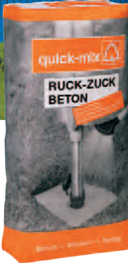
Ruck-Zuck-Beton schnellhärtender Beton zum Montieren und Fixieren von Zaunpfählen, Wäschespinnen etc., 25 kg ergeben ca. 13 Liter Fertigmischung, das Trockengemisch wird in Lagen von 10-15 cm eingebracht und mit Wasser begossen, schnell erhärtend, nicht für DIN-relevante Bauteile geeignet, 25 kg-Sack
