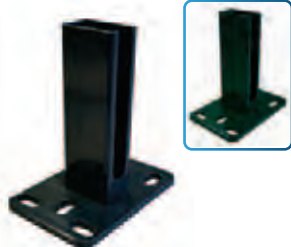
Montagefüße für Pfosten 60 x 40 mm zum Aufschrauben auf festem und ebenen Untergrund. 150 x 100 x 8 mm
