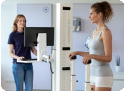
SCANNER UND KAMERA Muster aus unbedenklichen Infrarot-Lichtstrahlen werden auf die zu vermessende Person projiziert und digital erfasst. Die Software berechnet aus den Bildinformationen das exakte 3D-Abbild.
